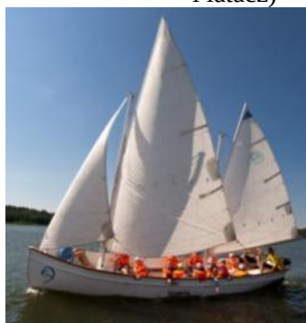
Kecz – grotmaszt (wyższy) i bezanmaszt; duży bezan; urządzenie sterowe za bezanmasztem
