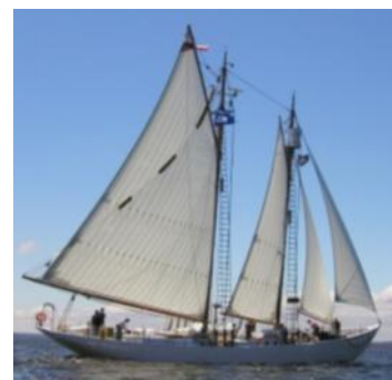
Szkuner – grotmaszt (wyższy), fokmaszt (maszt przedni niższy lub równej wysokości oba)
