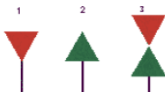
Rysunek 23. Oznaczenie miejsc niebezpiecznych na: 1) prawym brzegu, 2) lewym brzegu, 3) rozgałęzieniu szlaku.
